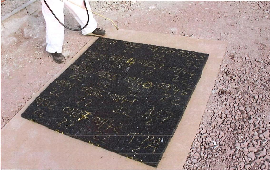
Abbildung 1: Probeplatten vor der Asphaltkonservierung
