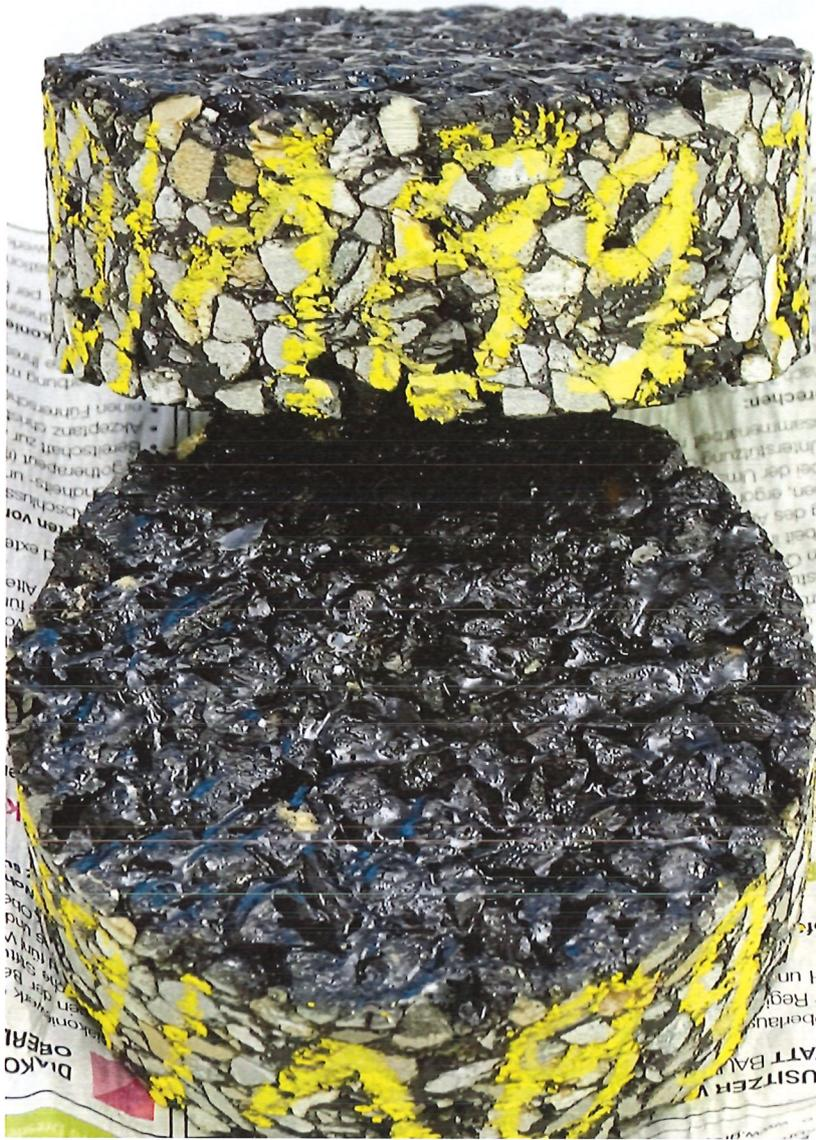
Abbildung 4: Beispiel herausgebohrter Asphaltprobekörper PA 8
