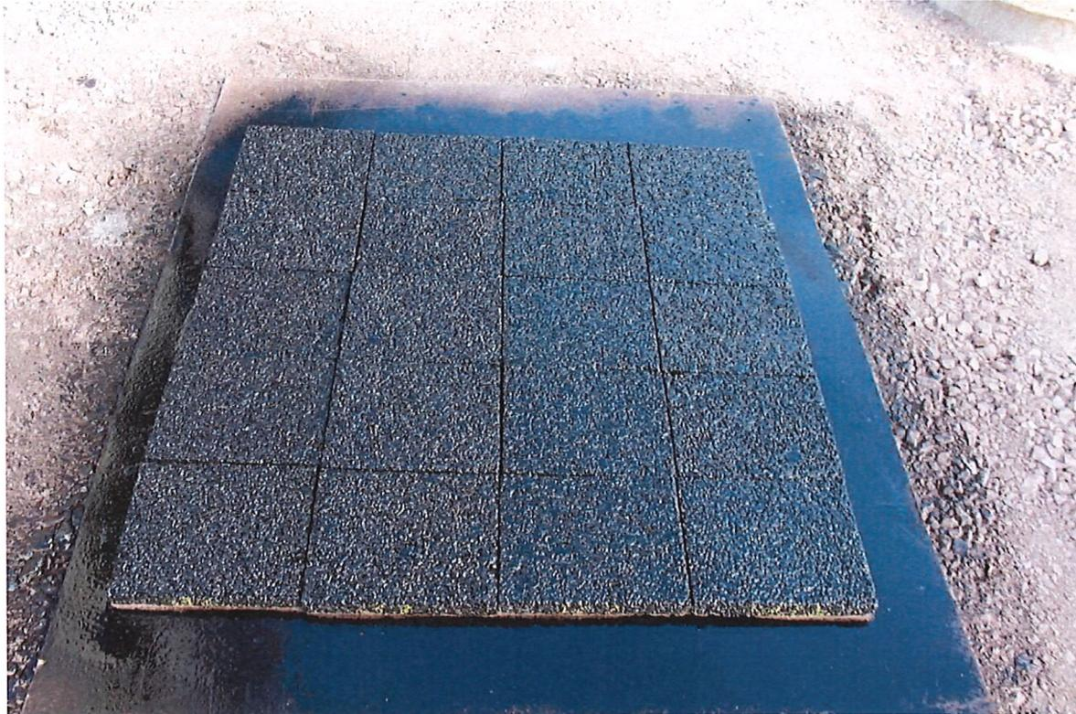
Abbildung 3: Probekörperplatten nach der Asphaltkonservierung
