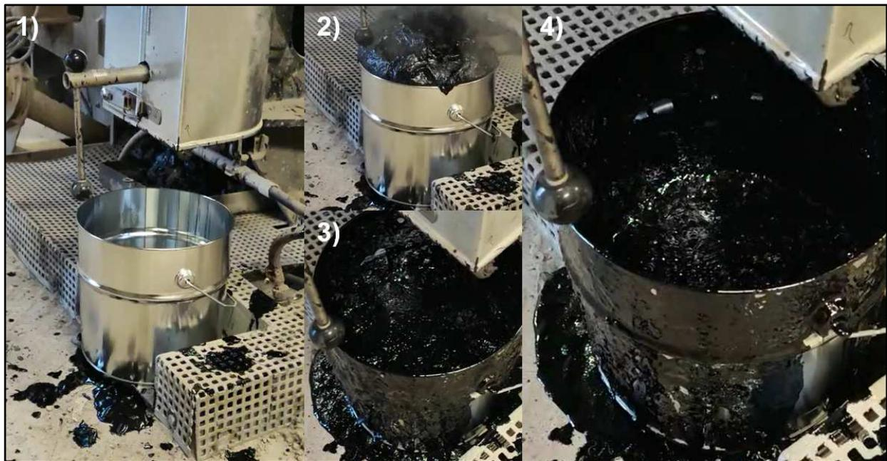
Abbildung 4-40: Entnahmevorrichtung und Schaumbitumenprobe (25/55-55 A (RC))
