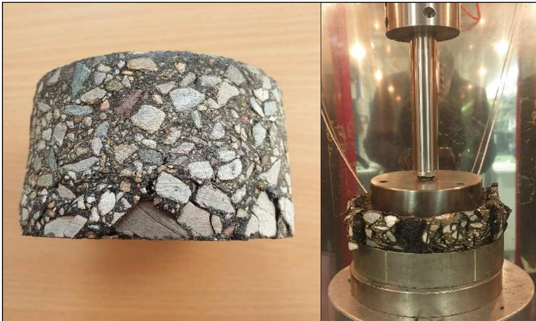
Abbildung 4-94: Beginnendes Versagen der Asphalttragschicht (links) und vollständiges Versagen des Bohrkerns (rechts)
