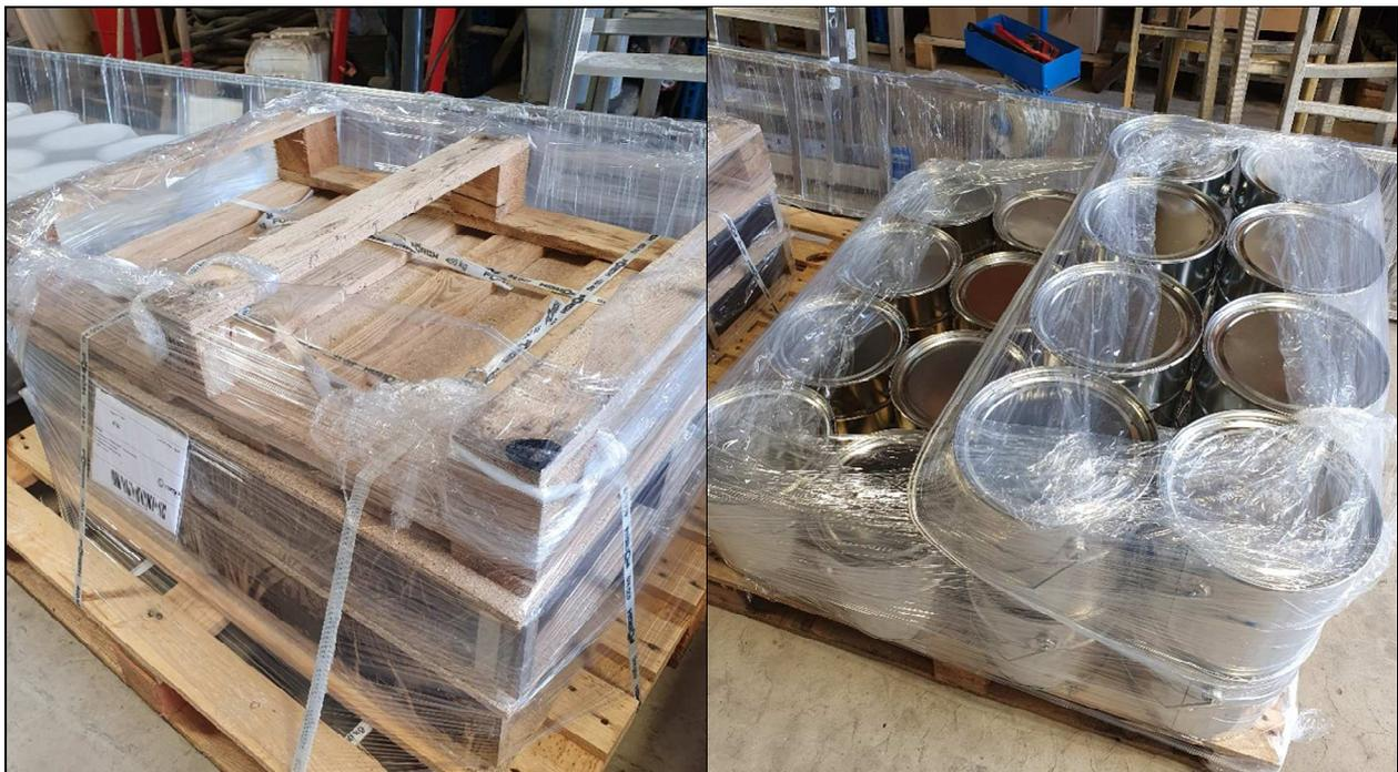
**Abbildung 4-46: Asphalt-Probepplatten (links) und Mischguteimer (rechts)**
