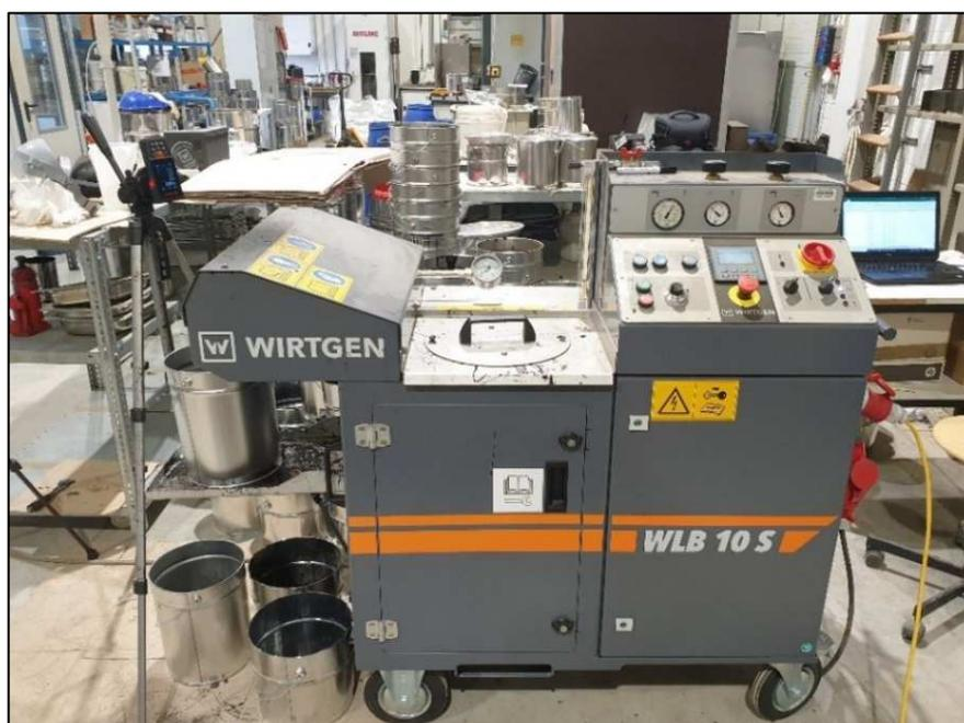
Abbildung 3-2: Schaumbitumenanlage WLB 10 S
