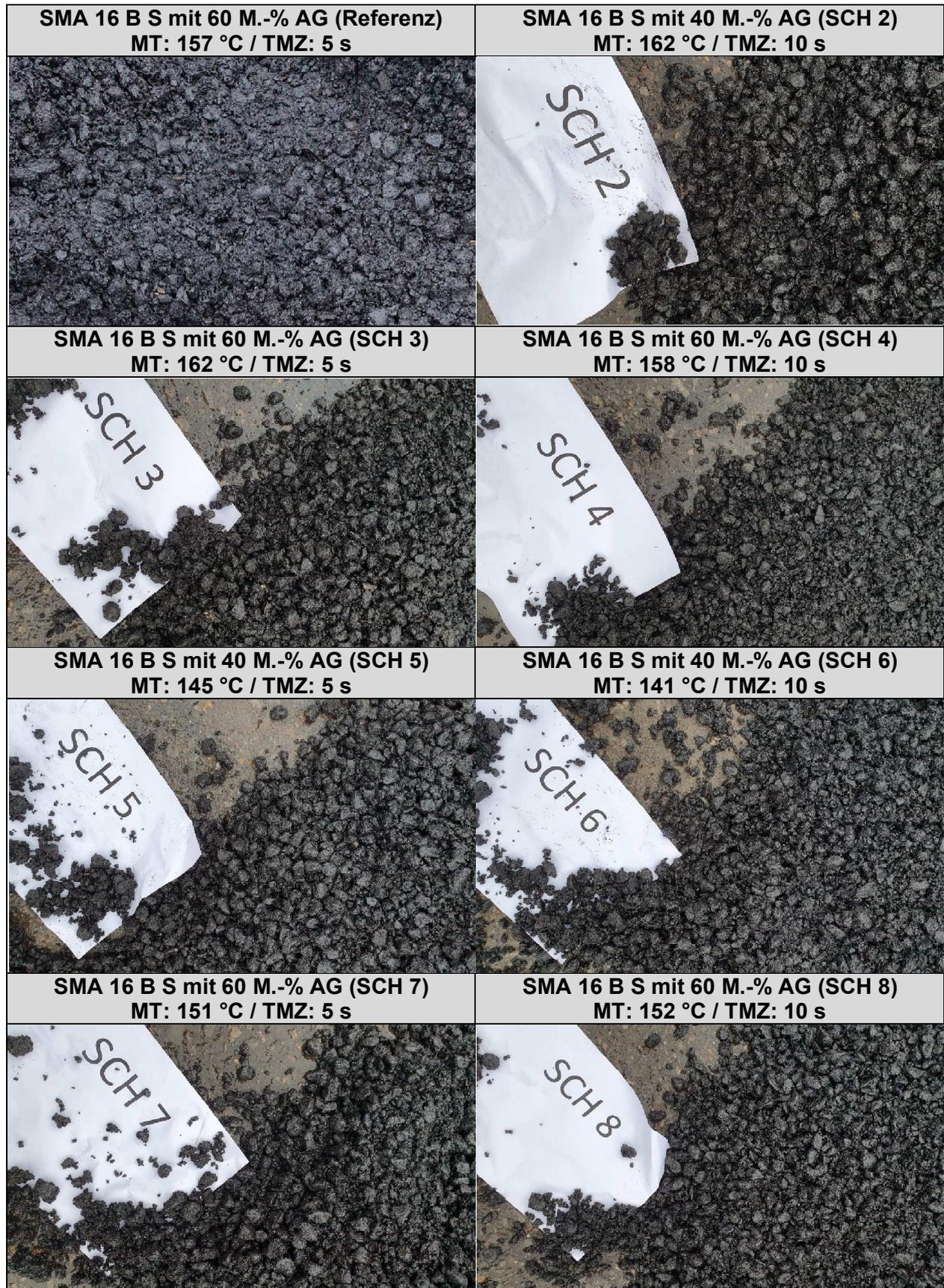
Abbildung 4-43: SMA 16 B S mit 40 M.-% und 60 M.-% Asphaltgranulat
