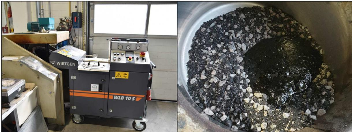
**Abbildung 3-4: Herstellung eines Asphaltmischgutes mit Schaumbitumen (Labormaßstab)**
