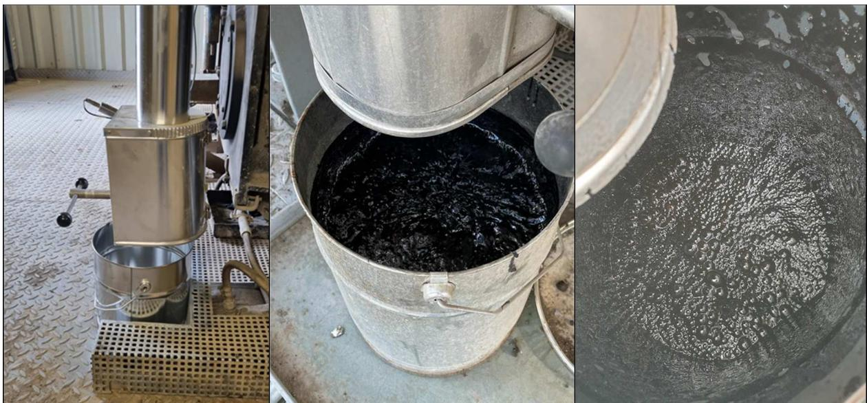
**Abbildung 4-81:** Probenahmeverrichtung für Schaumbitumen an der Mischanlage (links), Schaumbitumen unmittelbar nach Herstellung (Mitte), Schaumbitumen nach mehreren Sekunden (rechts)
