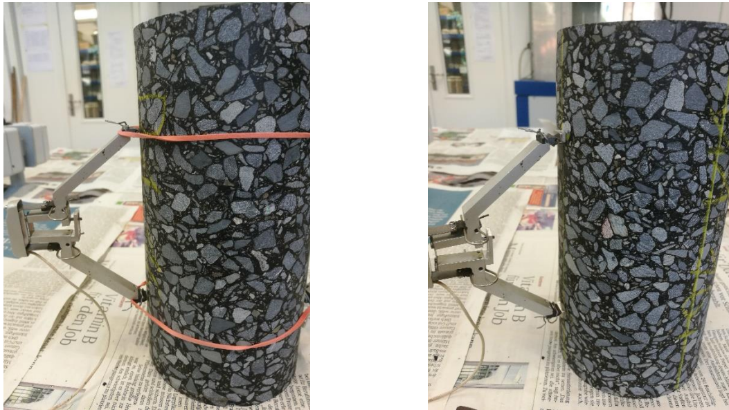
Abb. 3-6: Befestigung der Extensiometer mithilfe von Gummiringen (links) und Magneten (rechts)
