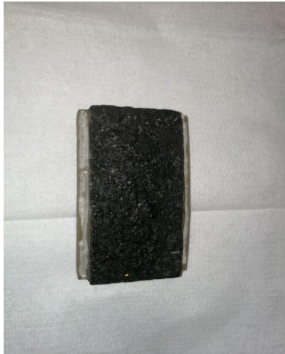
Abb. 3-17: Asphaltprobekörper des Darmstädter Polierverfahrens
