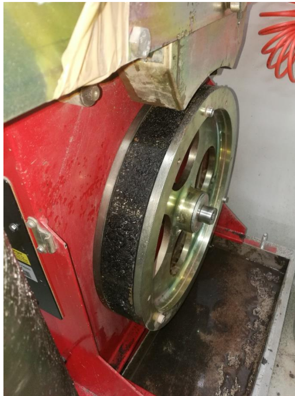
Abb. 3-18: Probenrad der Schnellpoliermaschine mit den Asphaltprobekörpern
