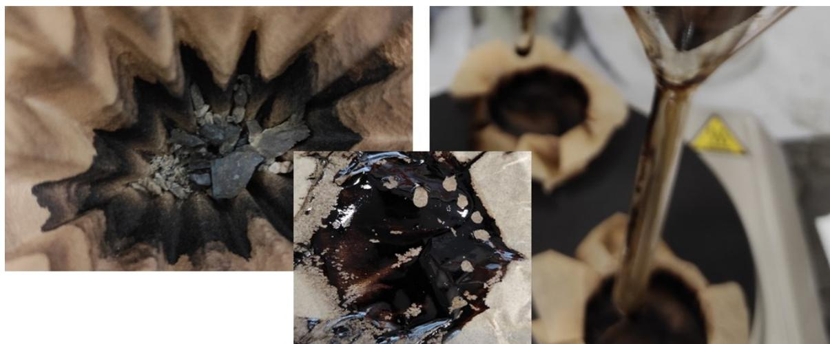
**Abbildung 11. Filtration und Extraktion von Ausbauasphaltpartikeln zur Gewinnung von Bindemittelproben für die FTIR/ATR-Analytik**
