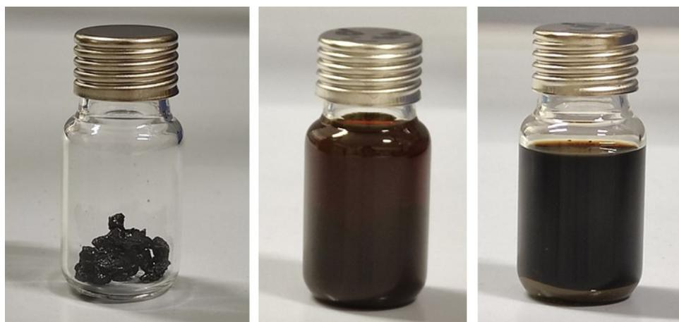
**Abbildung 12. Probenaufbereitung für die Schnell-Extraktion: Einfüllen der Granulatpartikel, Auffüllen mit Lösemittel und Probe nach Zentrifugieren.**
