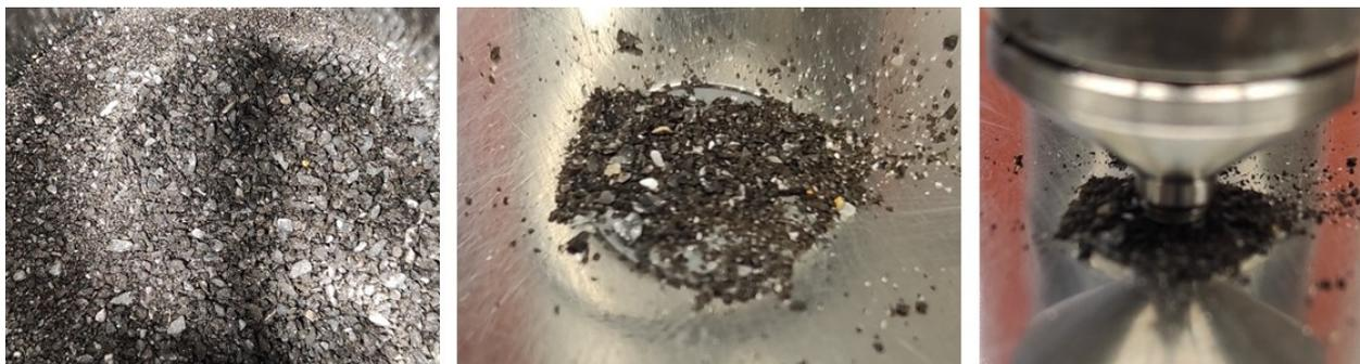
**Abbildung 6. Messung von fein abgeseibtem Asphaltgranulat**
