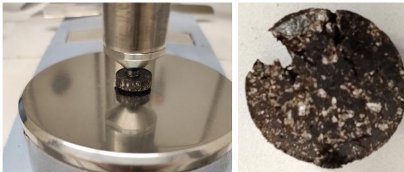
**Abbildung 7: Messung gepresster Asphaltgranulatproben**
