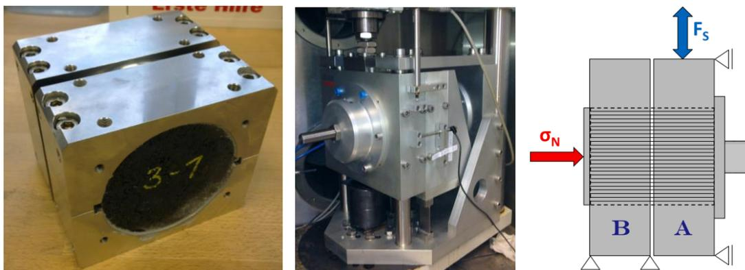
**Abbildung 1: Probekörper (links), geschlossene Prüfvorrichtung mit eingebautem Probekörper (Mitte) und Modell der Prüfvorrichtung (rechts)**
