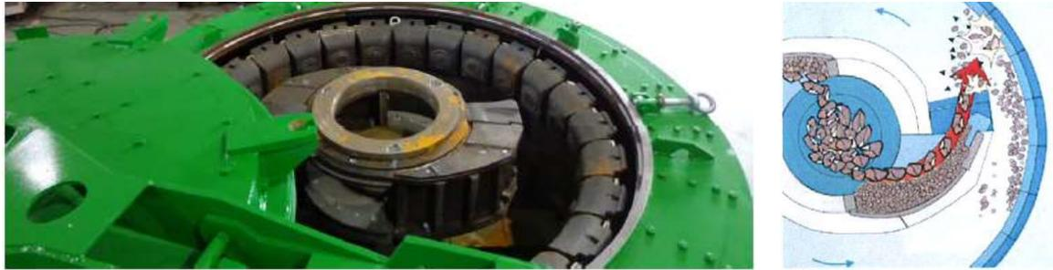
Abbildung 1: Rotorschleuderbrecher für die Aufspaltung des Asphaltgranulats in die bindemittelreiche Fraktion und die bindemittelarme Fraktion [22]
