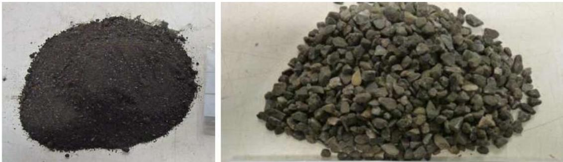
*Abbildung 2: bindemittelreiche Fraktion (links) und die bindemittelarme Fraktion (rechts) des in dem Rotorschleuderbrecher bearbeiteten Asphaltgranulates [18]*
